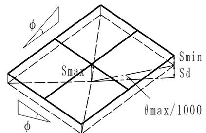
最大沈下量  $S_{max} = 3.52 \leq 5.0$  (cm) (OK)
