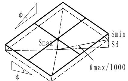
最大沈下量  $S_{max} = 0.03 \leq 5.0$  (cm) (OK)
