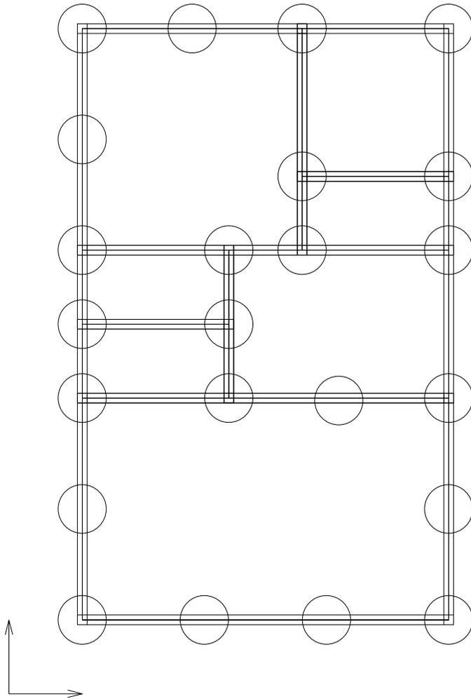
柱状地盤改良（深層混合処理工法）
