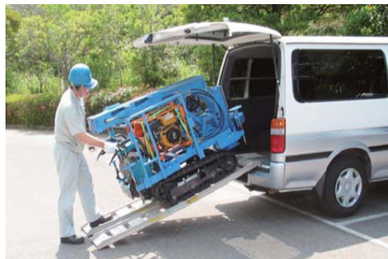
写真 13.1 車両搭載状況（2号機）
