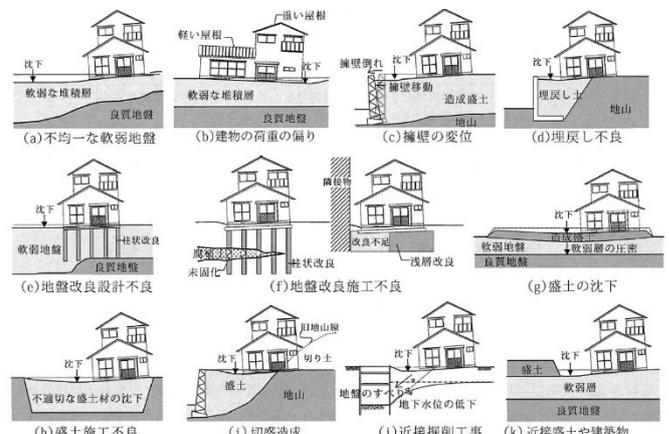
図2 不同沈下の原因例<sup>5)</sup>
