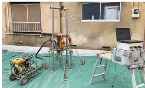
写真-1 住宅向けCPT調査機（左：調査状況、右：バンによる搬入出が可能） 写真-2 住宅向けCPT調査機（貫入ジャッキを足場パイプで固定する）
