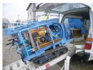
写真-1 住宅向けCPT調査機（左：調査状況、右：バンによる搬入出が可能） 写真-2 住宅向けCPT調査機（貫入ジャッキを足場パイプで固定する）
