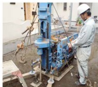
写真-1 住宅向けCPT調査機（左：調査状況、右：バンによる搬入出が可能） 写真-2 住宅向けCPT調査機（貫入ジャッキを足場パイプで固定する）
