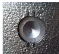
写真 3 加締め後の状態
