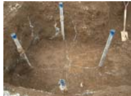
写真-2 注入固化体の割裂脈（左：パイプ@300,中：パイプ@450,右：パイプ@900）（代表深度 1.0m）
