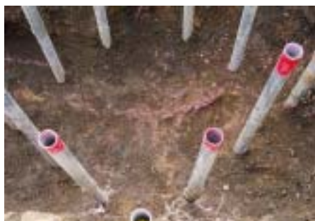
写真-2 注入固化体の割裂脈（左：パイプ@300,中：パイプ@450,右：パイプ@900）（代表深度 1.0m）
