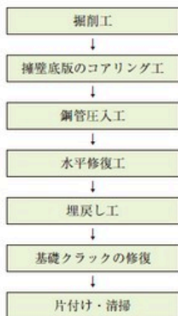
図-5 施工フロー
