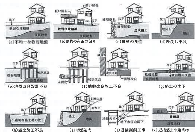
図-2 不同沈下の原因例
