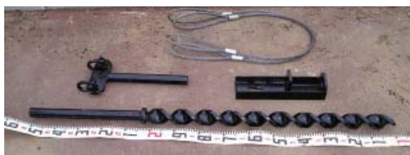
写真 2 スパイラル式アンカー
