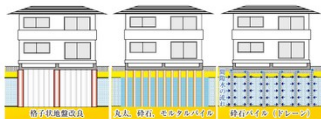
図-2 液状化対策（液状化防止）
