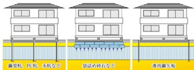
図-3 液状化対策（被害軽減）
